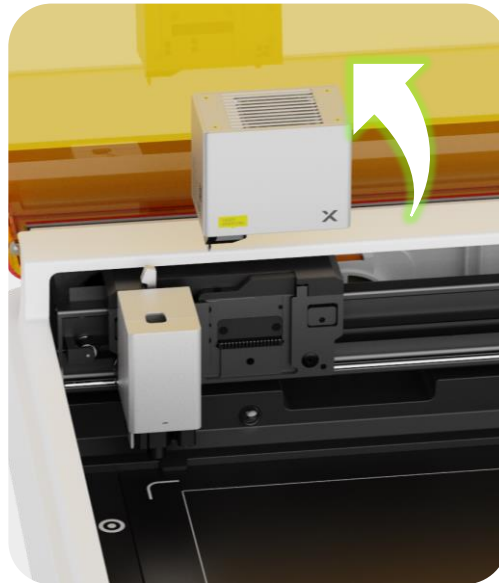
Remove the module 1
